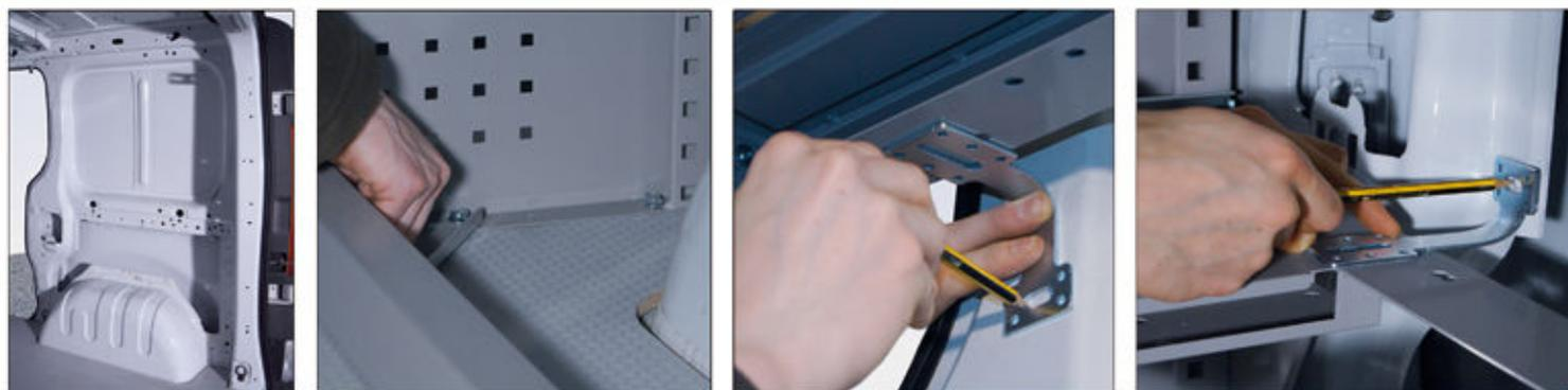
Après avoir retiré la paroi, fixez provisoirement le module au sol. Confectionner des équerres avec de l'acier de section 25 x 3 mm ou bien des BF 20 qui relieront l'arrière des éléments aux renforts structurels de la carrosserie. Positionnez-les et marquez en l'emplacement.
