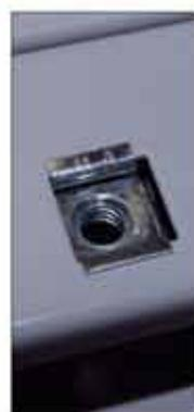
Positionner les **écrous cages** dans leurs **logements respectifs** sur chacun des panneaux latéraux à l'aide des **outils livrés**. Engager et comprimer l'encoche avant puis relever pour bloquer l'encoche arrière. **Pour plus de facilités, faire le montage à l'horizontal.**
