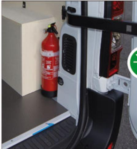
Fixer l'extincteur en utilisant des rivets "Pop" ou bien des visses auto-perforantes suivant la surface d'accroche.
