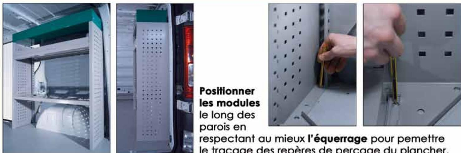
**Positionner les modules** le long des parois en respectant au mieux l'**équerrage** pour permettre le traçage des repères de perçage du plancher.
