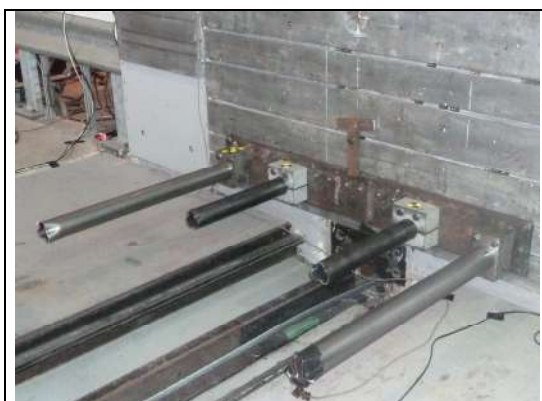
Photo 5 : Tubes d'arrêt fixés sur le mur de choc
