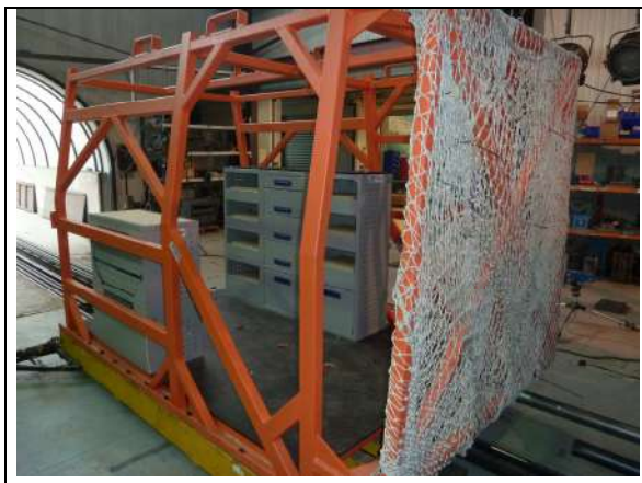
Photo 1 : Bâti mécano soudé + chariot de décélération
